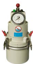
Ilmamäärämittari - kalibroitu 5 pisteessä - näyttää ilmamäärän %:na
