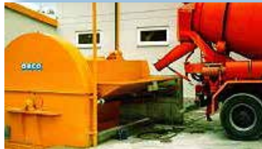
FLOTMAT-15-Kombi puhdistuslaitteellinen syöttöpyörä kahdelle pyörintäsäiliöautolle.
