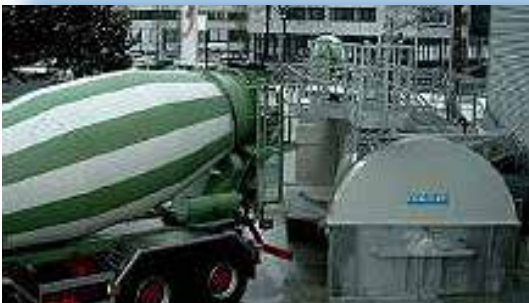
FLOTMAT-25-Kombi syöttöpyörä maantasossa pihan puhdistamiseen.
