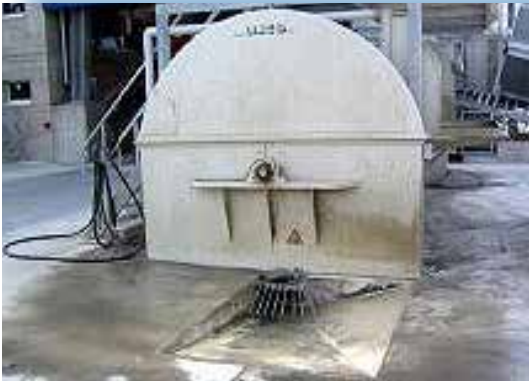
FLOTMAT-15-Kombi sisäänsyöttö maantasossa lattian puhdistamiseen.
