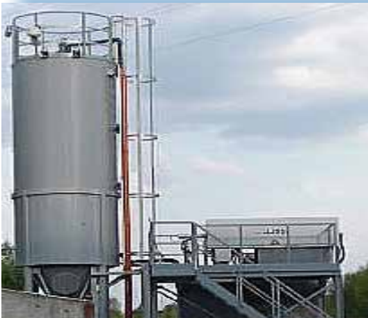
Vedenkäsittely-siilo AQUACLEAN ja säiliö-suotopuristin ECOPRESS.
