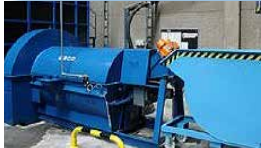
Kuivatustärykuljetin kiinteillä pyörillä, kuljettaa pestyn kiviaineksen säiliöön.
