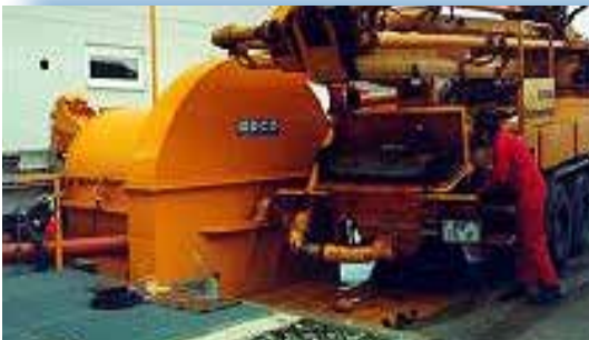
FLOTMAT-15-Kombi kuppisyöttöpyörä mahdollistaa pumppujen puhdistamisen.
