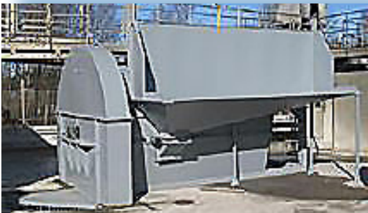
Flotmat-15-Kombi isolla syöttöpöydällä, sopii kahdelle pyörintäsäiliöautolle ja yhdelle betonipumpulle.
