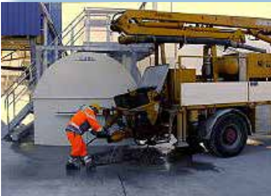
FLOTMAT-15-Kombi sisäänsyötöllä pumppujen puhdistamiseen.
