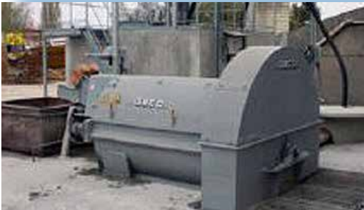
FLOTMAT-03-KOMBI, jossa pesuallas on maanpintaa korkeammalla.
