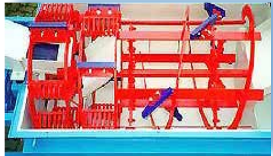
Toinen pesukammio säädettävillä ja itsepuhdistuvilla PU-lavoilla.
