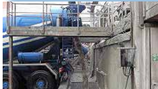
Syöttökouru, puhdistuslaite neljän pyörintäsäiliöauton samanaikaiseen puhdistamiseen.
